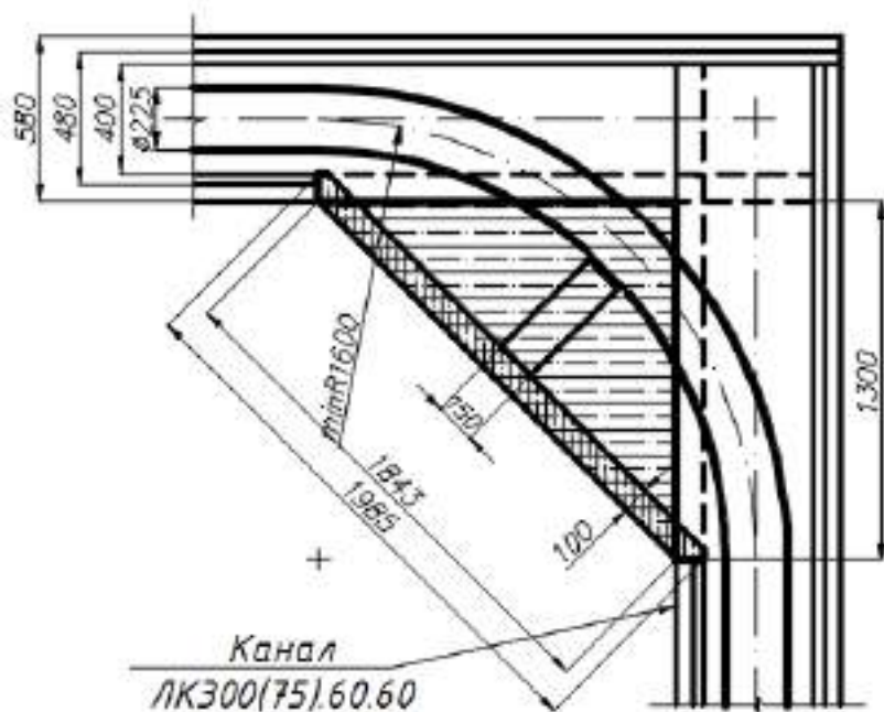
03) Закругление однотрубной прокладки трубопроводов ТВЭЛ-ПЭКС в оболочке 180мм, 225мм
